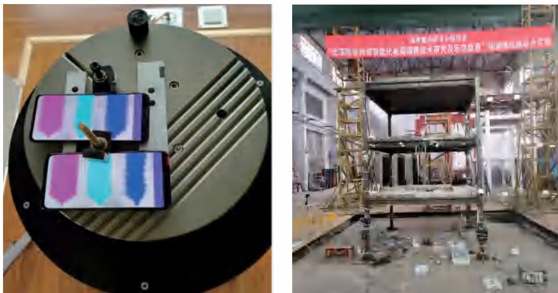
图 3.7 强震动观测数据服务的泛在振动传感地震预警设备的振动台检定测试
